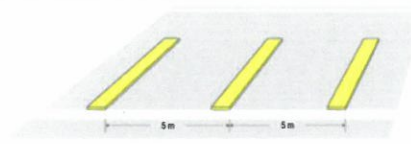
Anordnung von Warnschwelle auf dem Seitenstreifen alle 5 m
