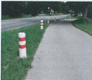
Zur Geh- und Radwegabtrennung bzw. Fahrbahntrennung Separation of road and bikepath or other lanes
